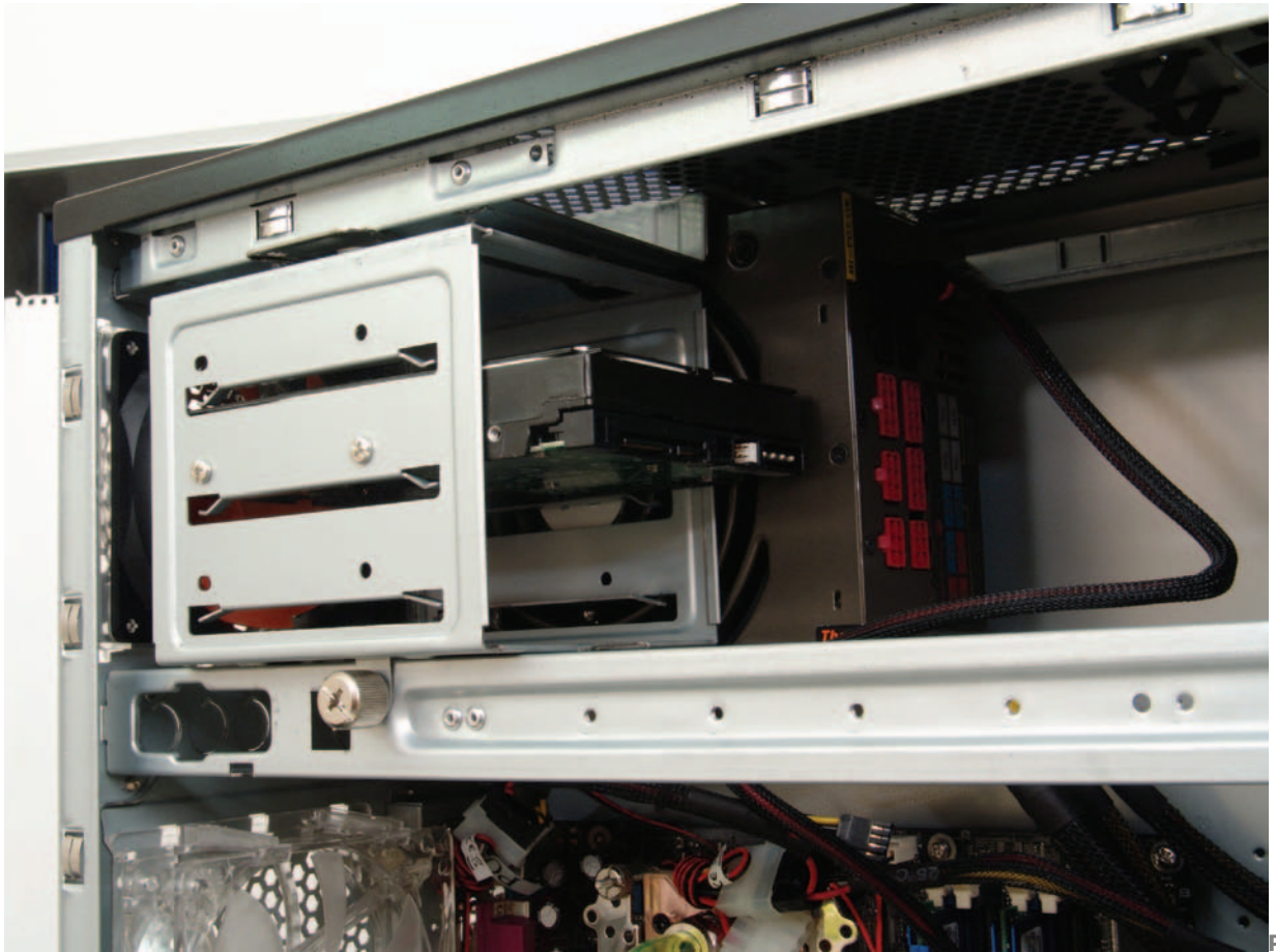
ис. 8. Жесткий диск обдувается сразу двумя вентиляторами.
