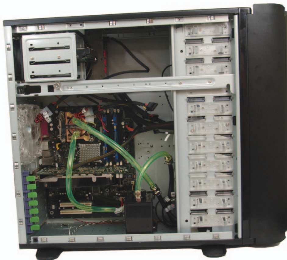
с. 4-5. ПК с установленной системой водяного охлаждения.
