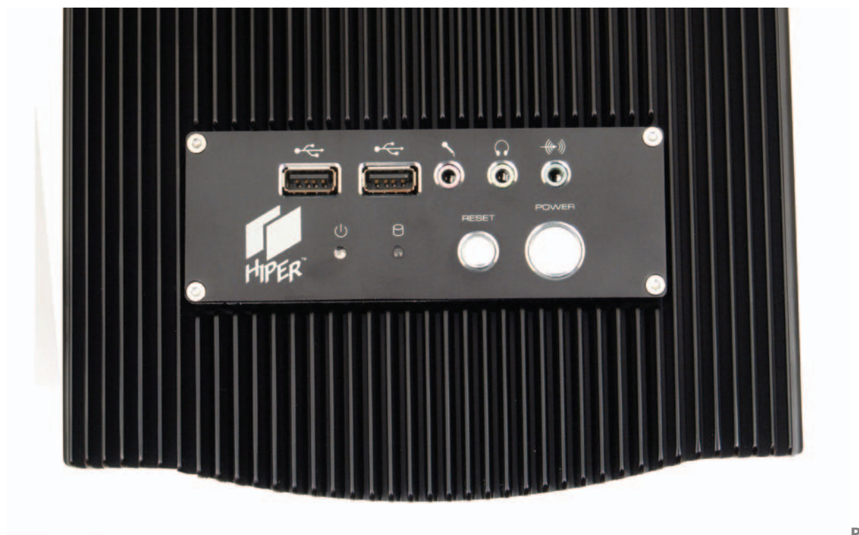
ис. 3. Системные кнопки и разъемы подключения сгруппированы в верхней части корпуса.
